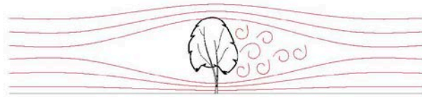
prodouvavý ochranný lesní pás, M 1:200 vznik tryskového proudění do vzdálenosti 5-8 násobku výšky stromu
