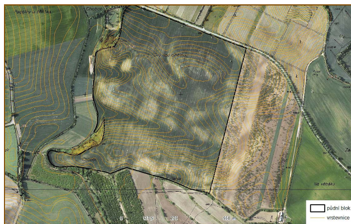
Obr. 3-10: Ortofotosnímek dílu půdního bloku, který poukazuje na poškození půdy vodní erozí (vybělená místa)
