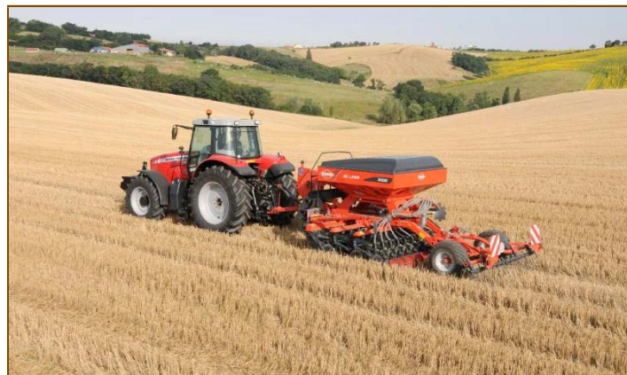
Obr. 4-9: Výsev kukuřice bezorebným secím strojem do rostlinných zbytků předplodiny (foto: Agrotec)
