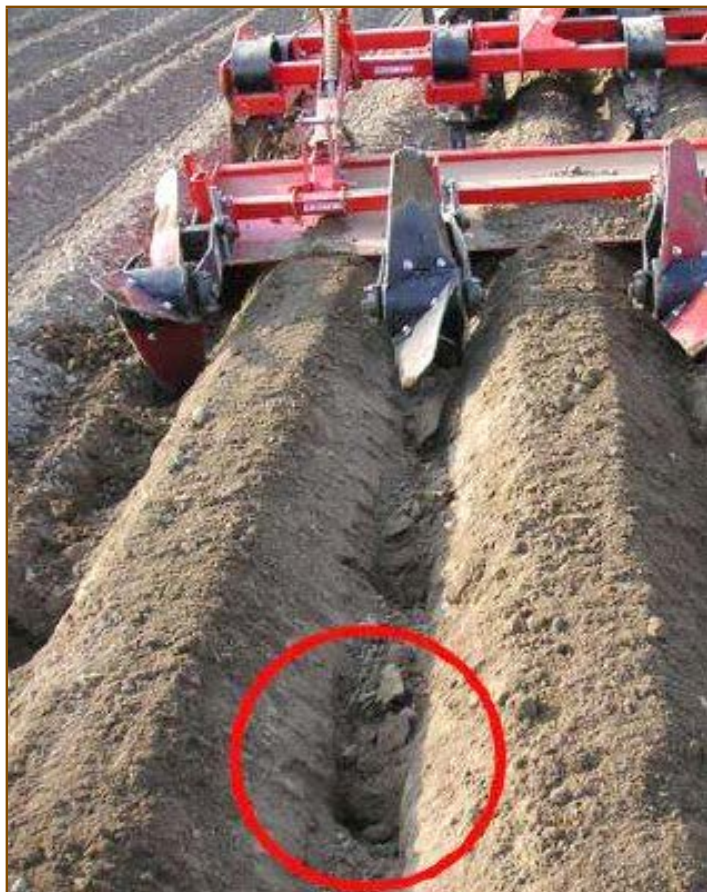
Obr. 4-15: Zařízení na důlkování brambor s detailem důlku v meziřadí brambor
