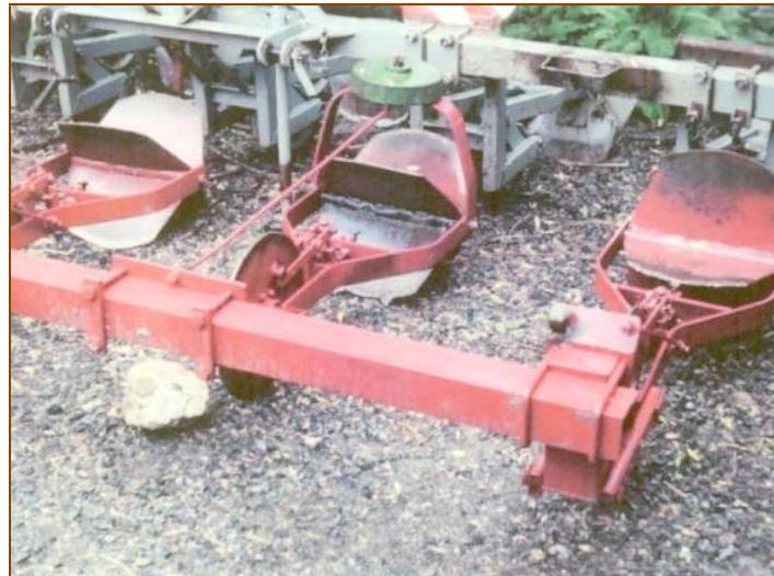
Obr. 4-14: Detail hrázkovače brambor
