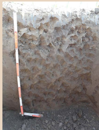
Obr. 3: Koluvizem modální (úpatí svahu) – původní horizont nahrazen akumulovaným erozním smyvem (v tomto případě výška akumulovaného materiálu přes 2 m) z výše ležících částí pozemku. Nově vzniká půdní typ koluvizem, profil sondy nese známky vrstevnatosti a v profilu není patrný původní povrch půdy díky mocným vrstvám usazeného erodovaného materiálu.
