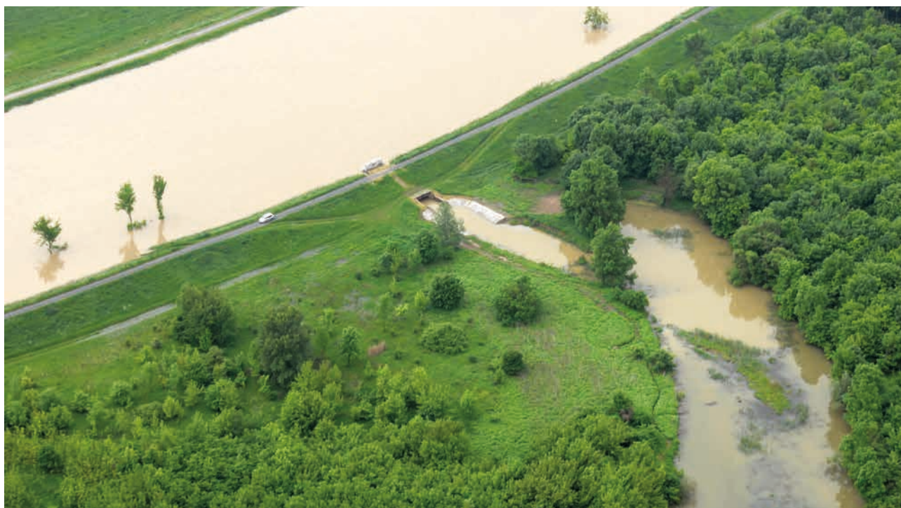
Odlehčování z řeky Moravy náplustným stavidlem v Týnci do obory Soutok (zdroj: Povodí Moravy)
