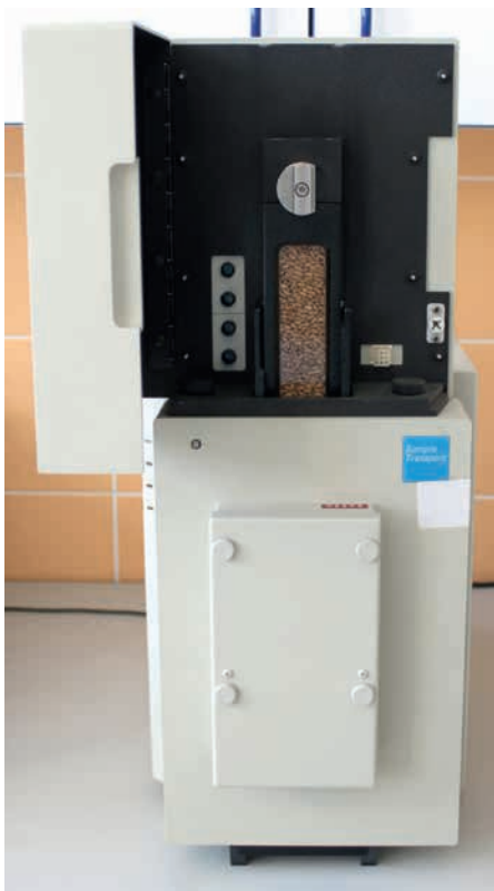
Měření intaktního zrna s využitím NIR spektrometrie
