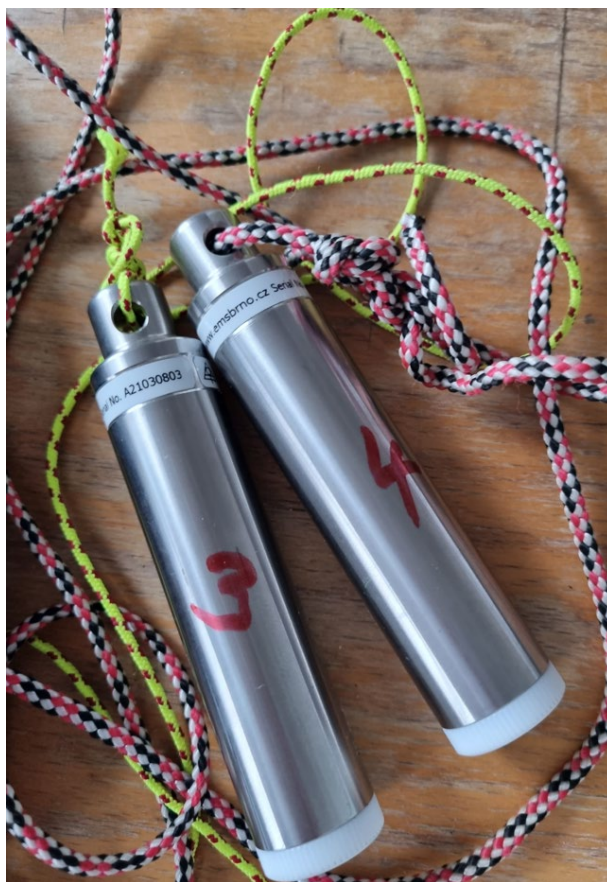
Obr. č. 5. Dataloggery pro automatické kontinuální měření teploty vody v odchovné nádrži.
