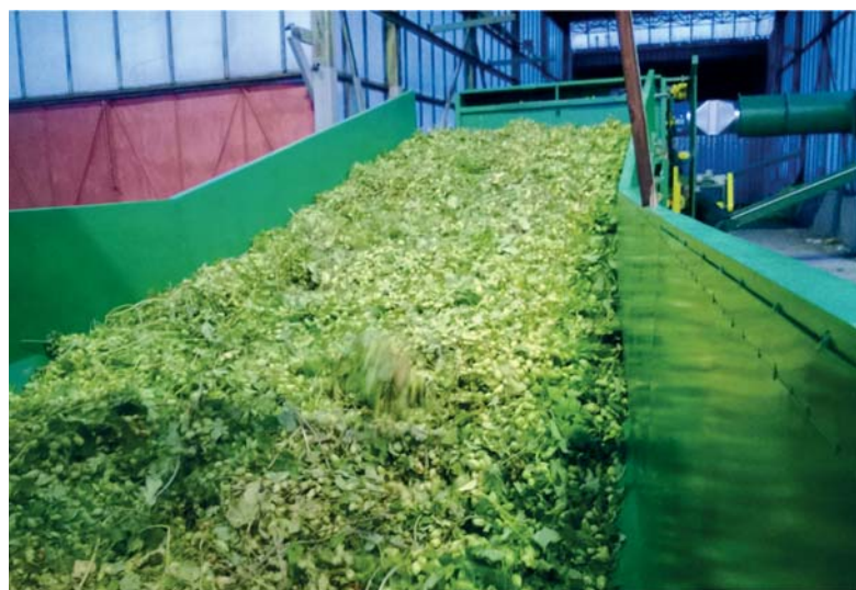
Feeding table for separation lines Dávkovací stůl separační linky
